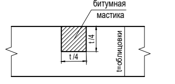
Конструкция строительного шва
